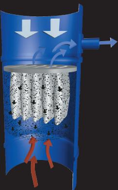
Pneumatische AirShock®-Filterabreinigung hält das Filtermaterial sauber und sorgt für gleichbleibende Saugleistung.
