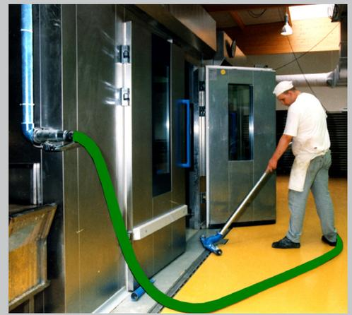
Reinigung der Backanlagen mit einer stationären Sauganlage.
