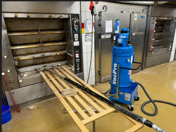
Ofenreinigung mit einem langen Saugrohr.
