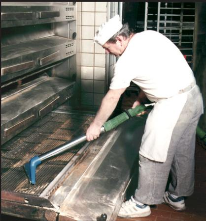
Absaugen der Backrückstände mit einem Industriesauger.
