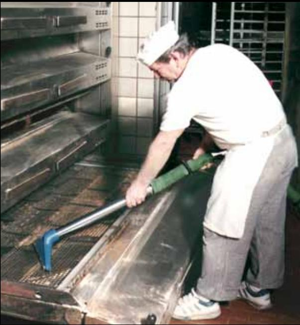
Absaugen der Backrückstände mit einem Industriesauger
