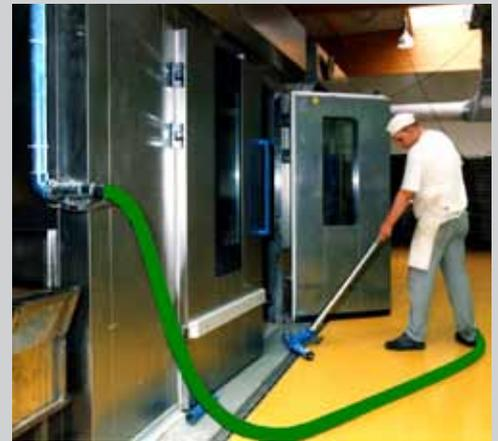
Reinigung der Ofenanlagen mit einer stationären Sauganlage
