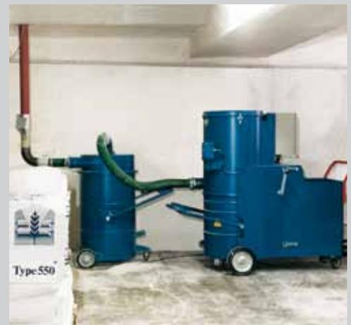
MaxVac Compact mit Vorabscheider, angeschlossen an ein Rohrleitungssystem
