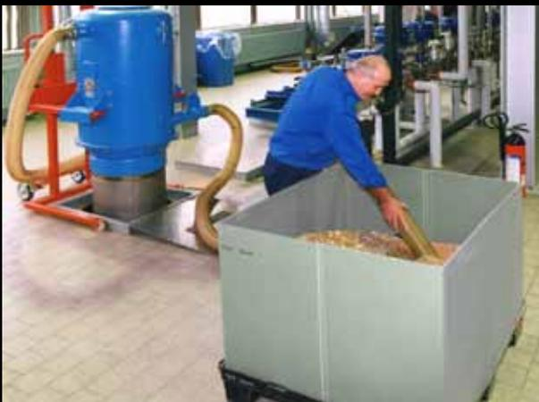
Zuführen von Gewürzmischungen zum Produktionsprozess mit Hilfe einer stationären Sauganlage
