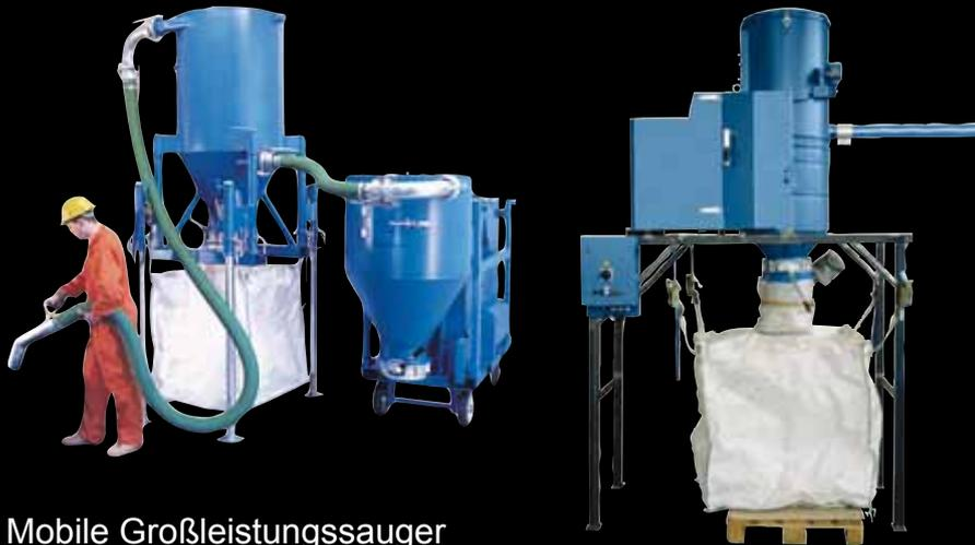
Mobile Großleistungssauger für Materialüberwurf an Förderbändern und zum Beseitigen von Störungen aufgrund von Materialanhäufungen
