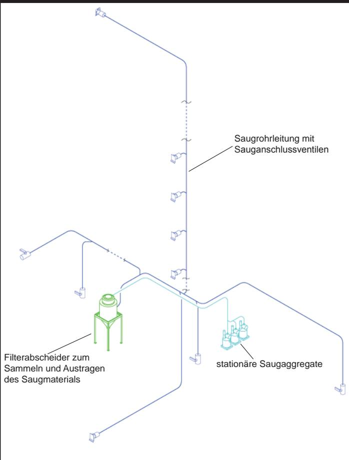
Betriebsreinigung in einem Mischfutterwerk mit einer stationären Sauganlage mit Rohrleitungssystem.
