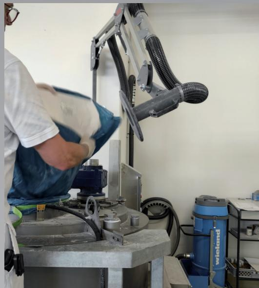
Absaugen von aufsteigendem Staub bei der Mischerbefüllung von Schüttgütern. Effektiv direkt an der Entstehungsstelle.
