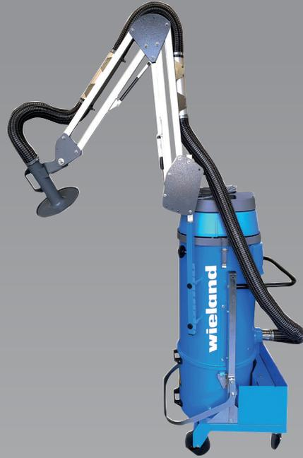
Fahrbare Industriesauger mit angebauten Absaugarmen oder kurzer Rohrleitung können auch für andere Saug- und Reinigungsaufgaben im gesamten Betrieb verwendet werden.
