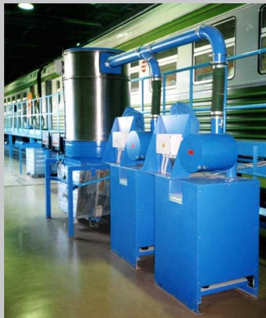
Doppel-Vakuumpumpen mit Filterabscheider für eine Saugstrecke von 200 m in beide Richtungen.
